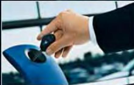
**KeyReader.** Mit ihm werden aus dem Fahrzeugschlüssel Modellbezeichnung, Kilometerstand, Fahrgestellnummer, Farb- und Polstercode sowie der aktuelle Servicebedarf ausgelesen.
